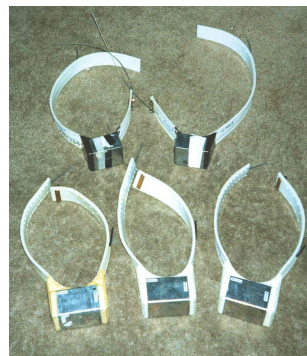
Kuvassa kaksi porojen radiolähetinpantaa sekä kolme satelliittilähetinpantaa
